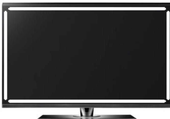
L'éclairage LED Edge est constitué de diodes dans les bords du cadre. Une surface réfléchissante assure la répartition de la luminosité sur toute la surface de l'écran.
