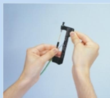
2. Positionner le connecteur sur l'accessoire de maintien et insérer la fibre.
